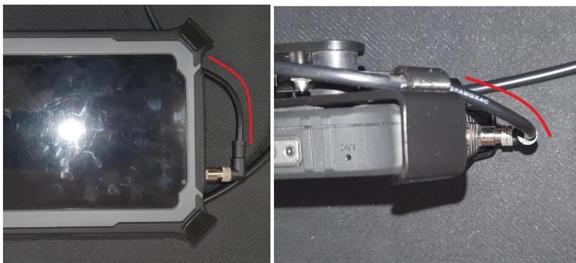
10.7. Se o cabo de carregamento M8 foi posicionado corretamente no suporte do cabo, seu comprimento livre permitirá a inserção fácil do conector no suporte do conector sem forçar o cabo em qualquer direção.
