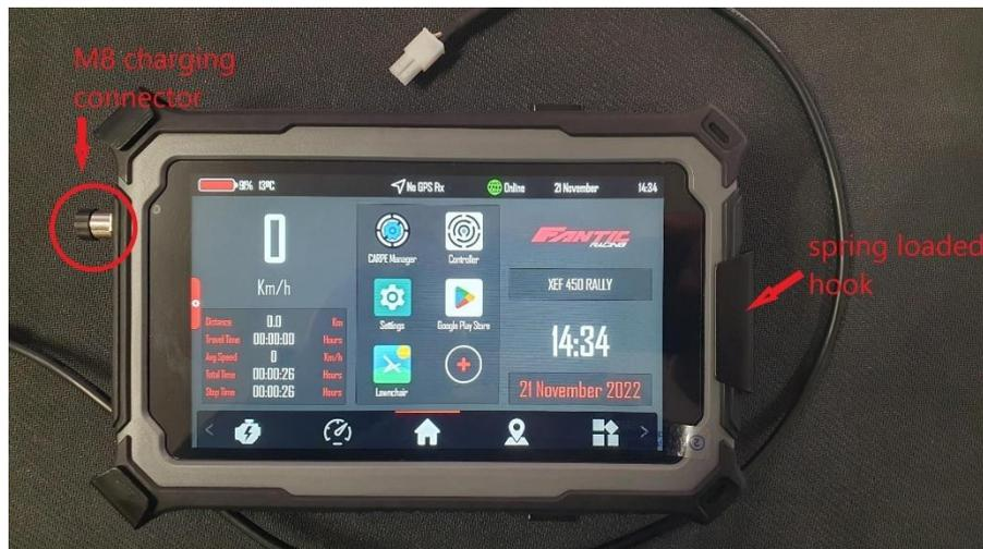
9.7.2. Nunca coloque o dispositivo no suporte em qualquer outra orientação além da indicada acima. Isso danificará os botões de hardware.
